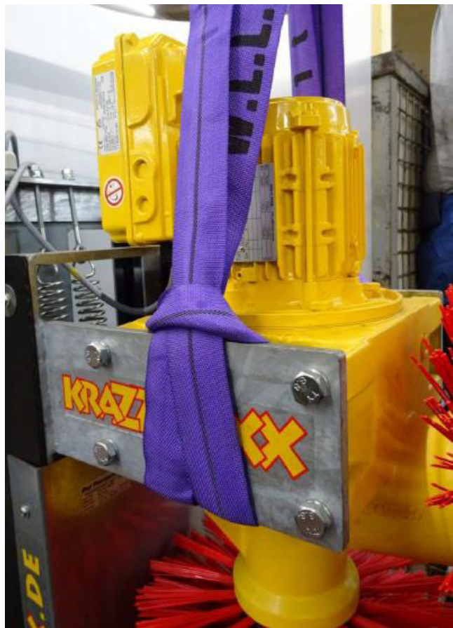
Illustration 3: fixation de la sangle de levage
