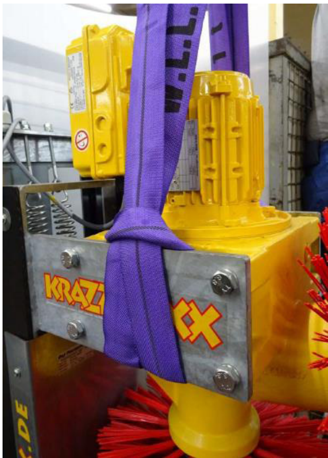
Abbildung 3: Befestigung des Hebegurtes
