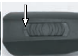
Kuva 5 Kytin ON-asennossa ("I")
